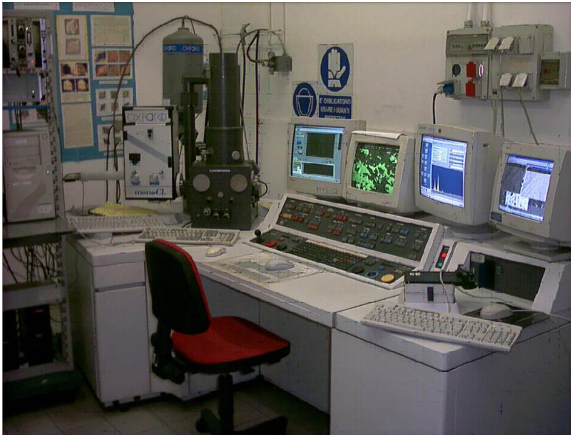
Foto 4: Postazione di lavoro per le analisi con microscopio a scansione SEM - EDS presso il Dipartimento di Scienze della Terra dell'Università di Torino
